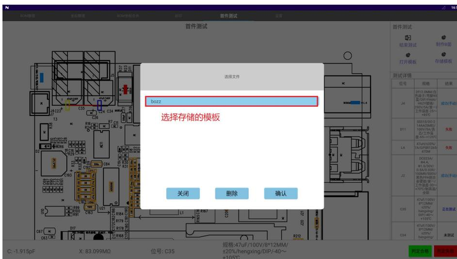
6.3 制作 B 面：在“首件测试”界面右侧的工具栏中点击【制作 B 面】按钮，系统会调整到丝印界面，重新导入 B 面的 PDF 文档的贴片位置属性图，按照上述操作步骤重新定位即可。
